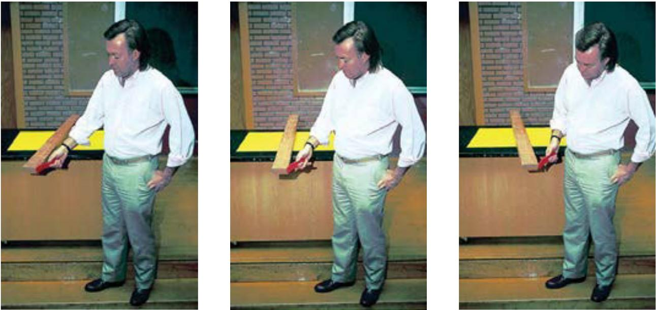
**Figura 10-5** La fuerza atrayente de una barra cargada hace girar una tabla normal de dos por cuatro equilibrada sobre un plato curvo.
