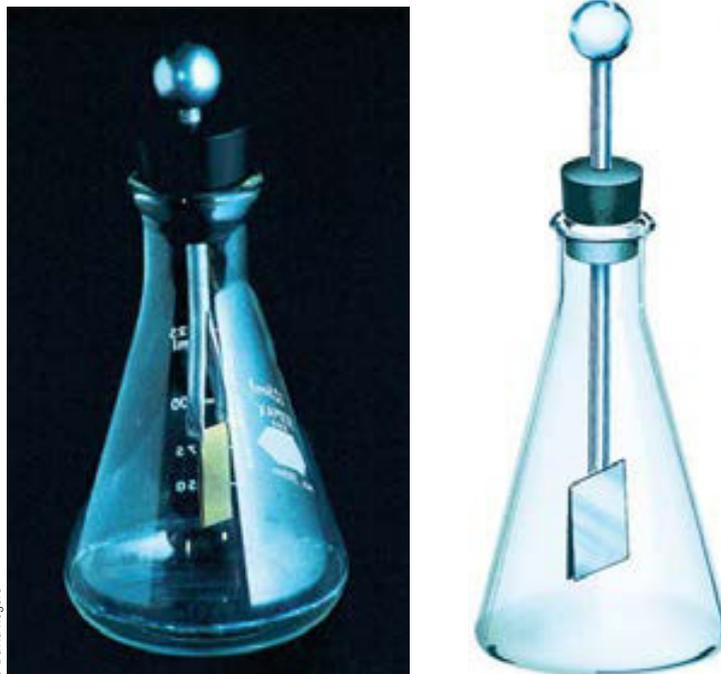
**Figura 10-6** Un electroscopio hecho con un matraz, una barra metálica y dos pedazos de hoja metálica delgadas.
