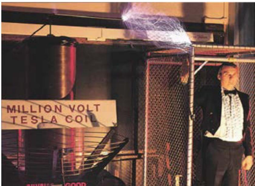
La jaula metálica protege al profesor Sprott de la descarga de alto voltaje.
